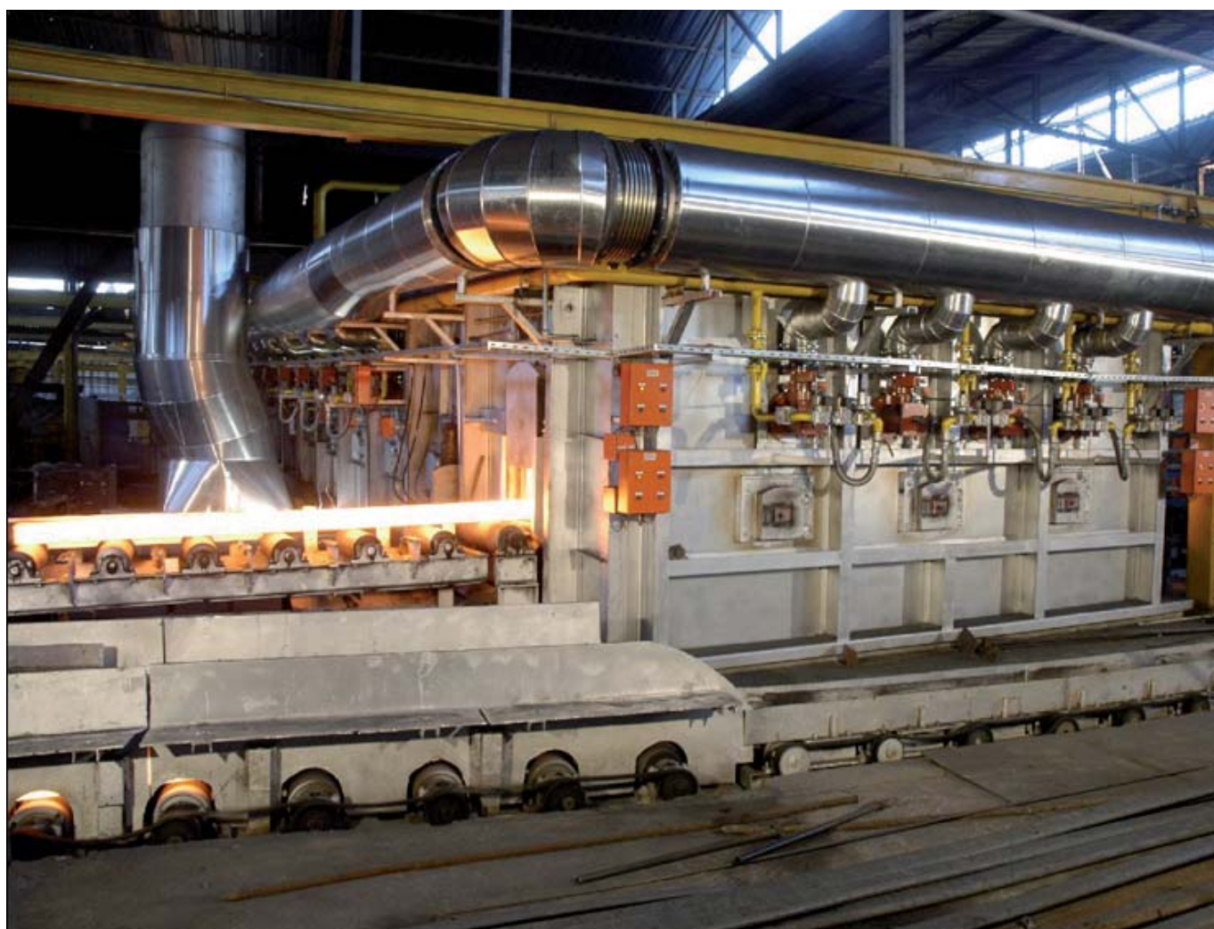
Stahlknüppel, der auf 1.250 °C erhitzt und zur Weiterverarbeitung aus dem Stossofen befördert wird
